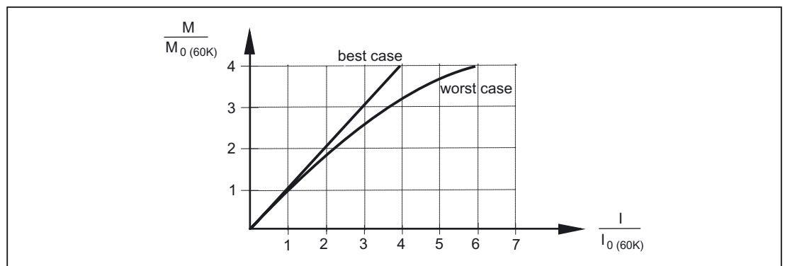
图 4-4 自冷却电机的扭矩-电流特性曲线特性走向
